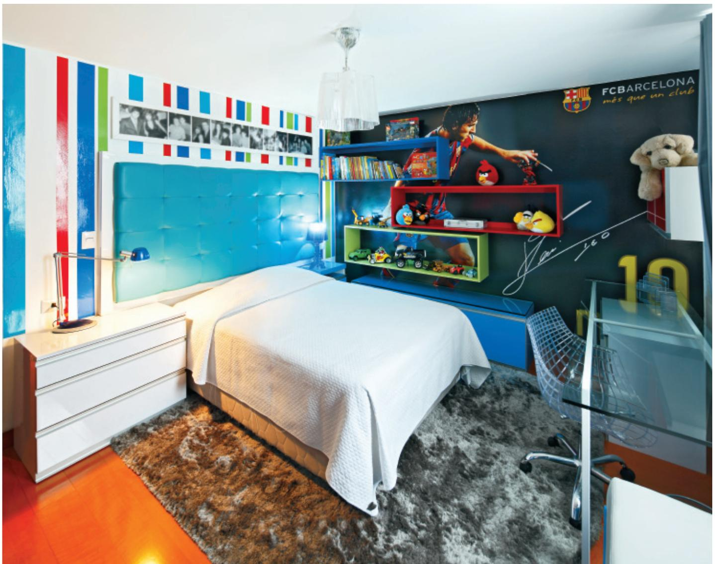
El escritorio se diseñó en una estructura de acero sobre un tablero de vidrio de 12 mm, refilado y pulido en los bordes. El mueble alto del escritorio está compuesto por dos módulos con puertas con sistema de pistón a gas, mientras que la cajonera cuenta con garruchas para facilitar su desplazamiento en la habitación.
