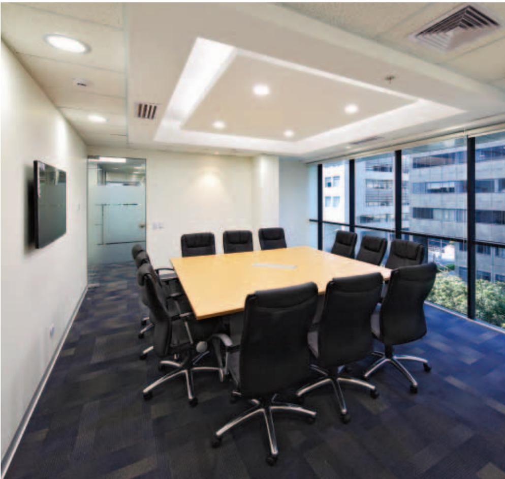
El diseño se realizó sobre una planta libre con una altura de piso a techo de 3.15 m y de 2.50 m hasta el falso cielo de drywall y baldosas acústicas. Para las divisiones se utilizaron mamparas de cristal templado y tabiques de drywall con pintura vinil acrílica en todos los casos, con excepción de los servicios higiénicos que forman parte del núcleo duro, propio del casco.
