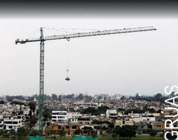
Grúas de gran capacidad de carga con altura autoestable de hasta 52 m., longitud de pluma de hasta 55 m., con facilidad de instalación en zonas reducidas por las medidas de sus tramos de 1190 mm de ancho.
