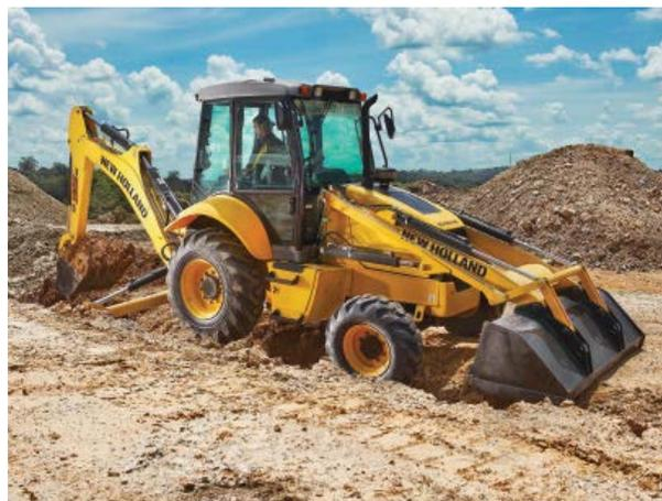
La bomba de pistones de caudal variable, por su parte, aumenta la respuesta y la velocidad del implemento; además, proporciona mayores fuerzas a cualquier velocidad del motor. Las válvulas hidráulicas de flujo compartido distribuyen automáticamente el elemento para optimizar el rendimiento del implemento multifuncional. Las válvulas de centro cerrado del implemento envían una señal con información sobre la demanda del sistema hidráulico a una válvula de control ubicada en la bomba.
