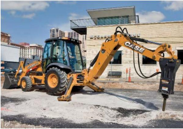
De igual modo, las mangueras se enrutan dentro de la estructura del brazo de elevación de la retroexcavadora para proporcionar mayor protección en aplicaciones peligrosas como demoliciones. Estas mejoras en el sistema hidráulico contribuyen a alcanzar una mayor eficiencia en el consumo de combustible.
