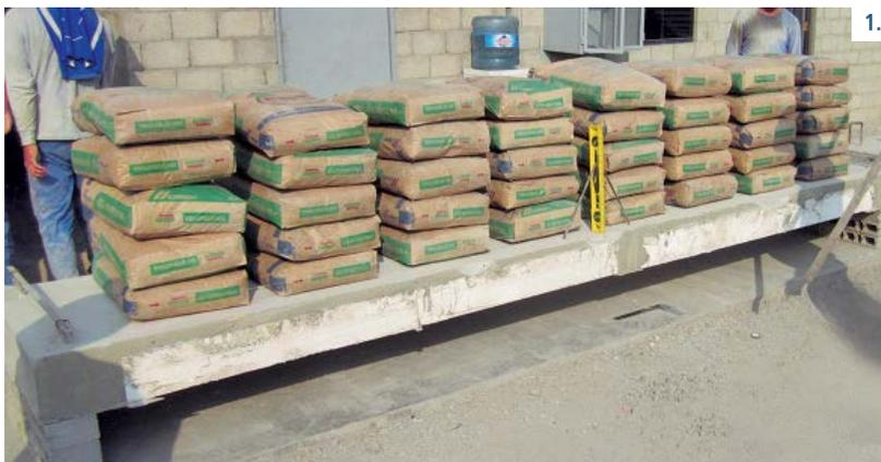
1. Descenso 3 mm. Cumple con el R.N.E Carga 425 kg/m<sup>2</sup> + Peso Propio.
