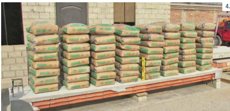
4. Descenso 27mm. No cumple con el R.N.E Carga 680 kg/m<sup>2</sup> + Peso Propio. Deformación permanente al retirar las cargas.
