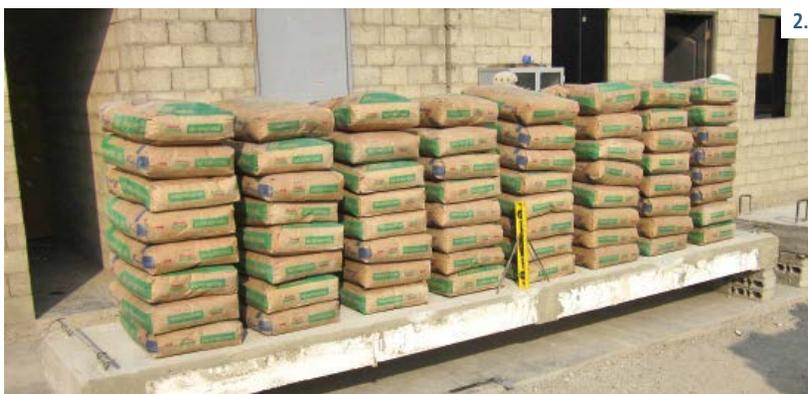
2. Descenso 12mm. Cumple con el R.N.E. Carga 680 kg/m<sup>2</sup> + Peso Propio. Recupera la flecha inicial al retirar las cargas
