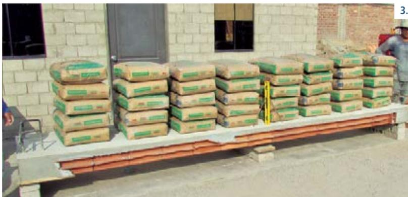
3. Descenso 17mm. No cumple con el R.N.E. Carga 425 kg/m<sup>2</sup> + Peso Propio.
