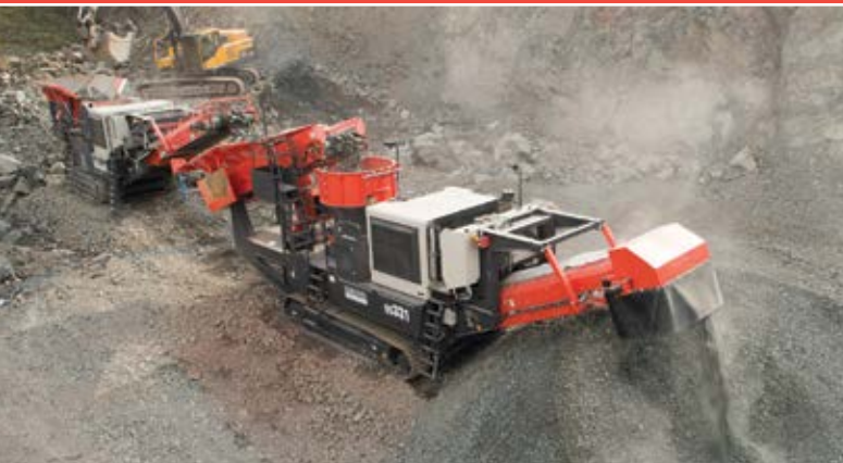
Nueva trituradora de cono QS331 que puede recepcionar hasta un tamaño de 14"
