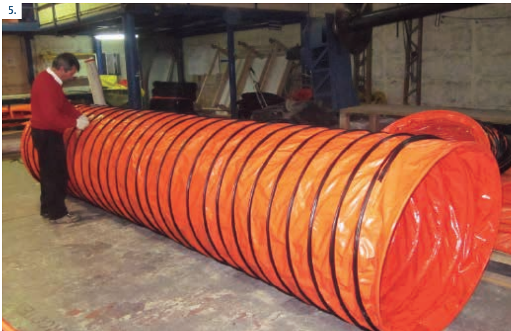
4 y 5. Las mangas de ventilación se fabrican según la necesidad de cada operación, tanto en sus diámetros como en sus largos, así como demás dimensiones.
