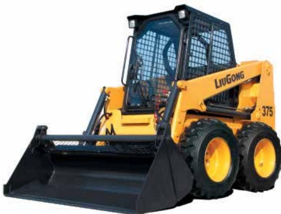
El diseño de ciertas cabinas elimina la necesidad del tubo de par de torsión trasero que se encuentra en los equipos de levante vertical competitivos, lo cual mejora aun más la visibilidad trasera.
