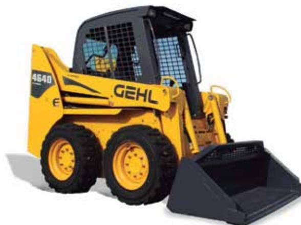
carga mientras que incrementa el confort del operario. La opción de Lift Parallel ayuda a mantener las cargas a nivel a través del ciclo de levante: un mayor beneficio cuando maneja material suelto o cargas paletizadas. El alto flujo hidráulico expande la gama de aditamentos que pueden ser utilizados con el equipo.
