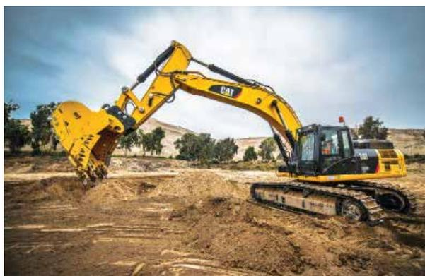
El equipo posee una gran capacidad de cucharón, hecho de un material de alta tenacidad y de elevada resistencia al desgaste. Cuenta con un poderoso motor Cummins de 6 cilindros e inyección directa que garantiza una combustión normal y reduce la emisión de gases de escape.
