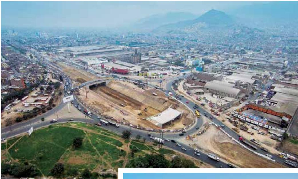
*El Naranjal, aún en ejecución, será un intercambio rotatorio a desnivel con la Panamericana Norte deprimida en zanjón y la glorieta ejecutada mediante ramales de tipo directo que también transcurren a nivel del terreno (cota 0).*
