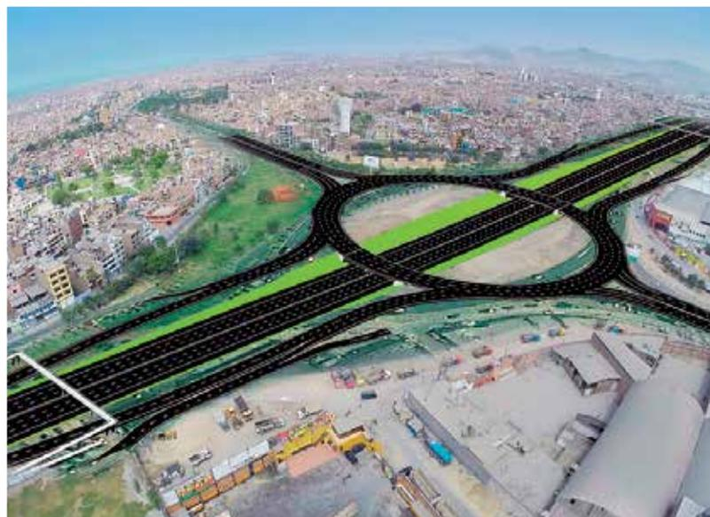
En el caso del ramal noreste, la sección se mantiene siempre con dos carriles debido a la limitación de espacio existente (no caben bocinas de salida y entrada consecutivas al ser muy próximas). La salida de los vehículos a la vía auxiliar se realiza mediante un carril de deceleración de tipo directo situado a unos 50 m de la salida desde la glorieta.
