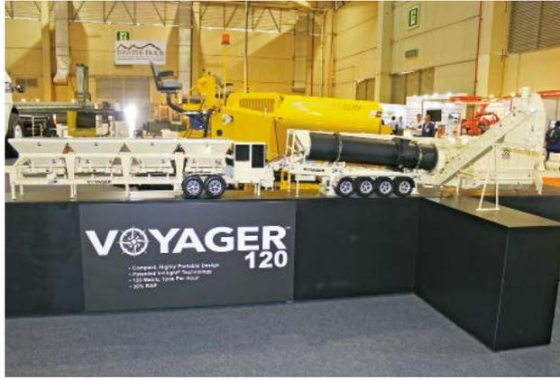
La Voyager 120 ofrece un diseño compacto y altamente portátil. Una planta única en su clase, con la capacidad de funcionar con hasta 30% de RAP
