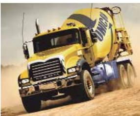
El concreto premezclado tiene una amplia utilización en las estructuras de concreto más comunes. Disponible en diferentes resistencias (desde 175 hasta 350 kg/cm<sup>2</sup>), entre sus ventajas se encuentran que el control de calidad de las materias primas y del producto final es riguroso y con la más moderna tecnología. El producto, que es totalmente garantizado, permite el ahorro en insumos y mano de obra versus el concreto hecho en obra.
