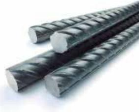
Se usan barras rectas de acero cuyos resaltes permiten la alta adherencia con el concreto, cumpliendo la norma ASTM A615, Antisísmica Grado 60. Otra que cumple es la Norma NTP 341.031-2008, la cual es una especificación normalizada para barras de acero con resaltes y lisas para concreto armado. La principal aplicación de este producto es en el sector de la construcción, empleándose como refuerzo de concreto en estructuras con diseño sismorresistente.
