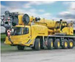
Posee una pluma de 12.8 m a 51.0 m y cinco tramos de telescopaje TWIN-LOCK. Logra una altura máxima en punta de 54 m. Tiene un sistema indicador del momento de carga y de final de carrera del gancho, con alarma audiovisual y bloqueo automático de las palancas.
