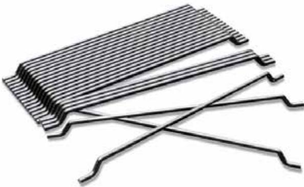
Las fibras de acero Dramix® están hechas de alambre de acero trefilado en frío para asegurar una alta resistencia a la tracción. Sus extremos conformados garantizan un mejor anclaje en el concreto.
