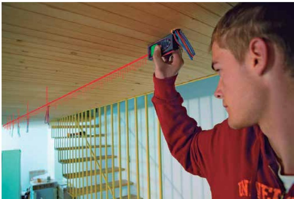
**E**l medidor láser de distancia emite un pulso láser a un determinado objetivo en el cual se refleja para después volver al mismo dispositivo. Este es el principio conocido como “tiempo de vuelo” y se basa en que la luz láser viaja a una velocidad constante a través de la atmósfera de la tierra.
