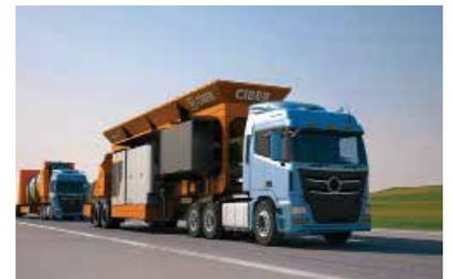
La máquina alía el concepto de la planta ultra móvil con alta capacidad de producción. A la unidad se la transporta e instala en dos chasis y producción que varía entre 100 y 200 t/h. De este modo, los costos de transporte terrestre y marítimo son significativamente más bajos, así como los de instalación. ■
