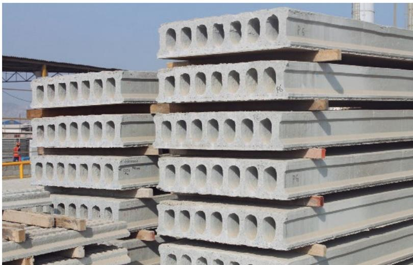
Las losas alveolares son elementos de concreto pretensado que permiten obtener sistemas de mayor capacidad de carga y menor espesor con respecto al concreto armado convencional.
