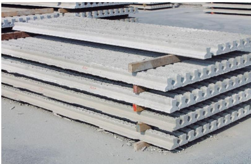
Las losas aligeradas con viguetas pretensadas forman parte de una solución fácil y eficiente para el techado de viviendas, oficinas u otras edificaciones. Está constituido por viguetas prefabricadas pretensadas, bovedillas y una capa de compresión de concreto vaciada in situ.
