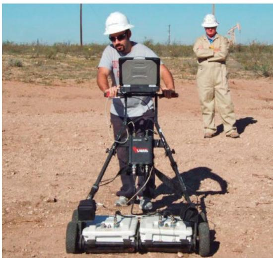
⬅ Radar de penetración o GPR IDS Geo Radar.
