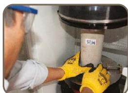
Ensayo en prensas automatizadas
