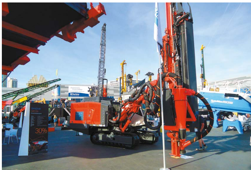
El sistema de automatización de la Pantera DP1100 | permite que el equipo trabaje por sí mismo durante todo el barrenado.
