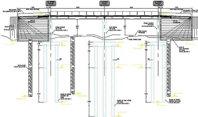
Fig. 4: Perfil Longitudinal del puente San Nicolás
