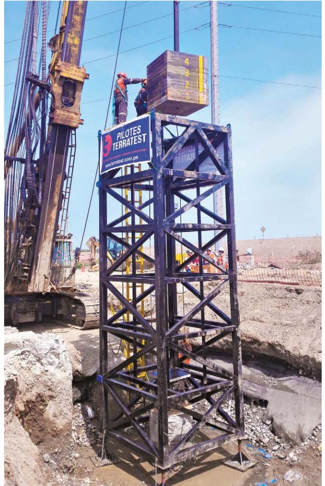
Fig. 5: Ensayo de Carga Dinámica ejecutado sobre un pilote definitivo
