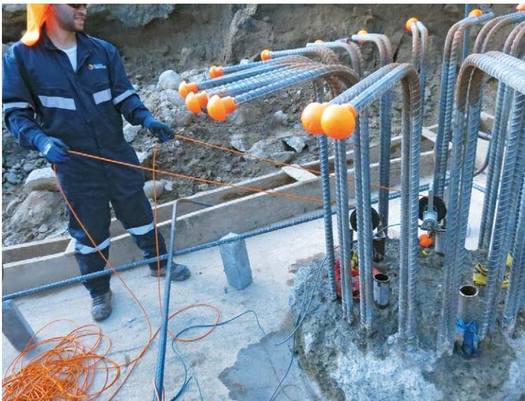
Fig. 6: Ejecución del ensayo de integridad Cross Hole
