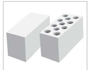
El ladrillo sílico calcáreo KK-11H es una unidad de albañilería compuesta de una mezcla de arena fina natural, cal hidratada y agua. Tiene la particularidad de que las perforaciones no llegan a la cara de asiento superior, es decir que presenta tapas en la cara de asiento lo cual brinda el beneficio de evitar el desperdicio o merma al colocar el mortero sobre el ladrillo. Además proporciona una mayor superficie de contacto para mayor adherencia.
