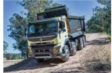
como estándar, pero pueden tener potencias que van de 400 a 520 hp. “Destinado al transporte de cargas en la gama de 34 a 50 Tn de peso bruto vehicular (PBV), el FMX ha sido especialmente desarrollado para el transporte pesado en condiciones severas, desde aplicaciones en la construcción y minería hasta en la agricultura”, declaró Marcus Hörberg, director general de Volvo Perú.
