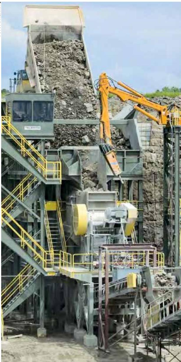
**El sistema hidráulico del J3858 proporciona protección con la sobrecarga.**
