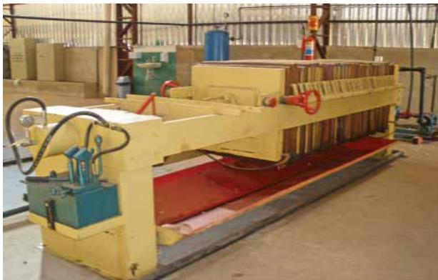
Dos de las ventajas que tienen los filtros serie APN es su menor potencia instalada y bajo consumo de energía con sistema load sensing.
