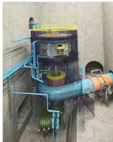
Refuerzo de la turbina.
