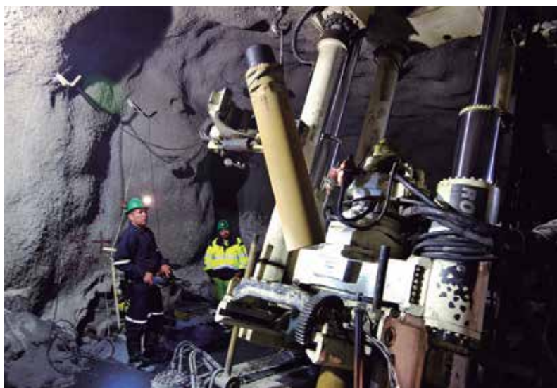
La contra pocera Robbins 34RH C QRS de Atlas Copco en la superficie durante el montaje y en acción bajo tierra.
