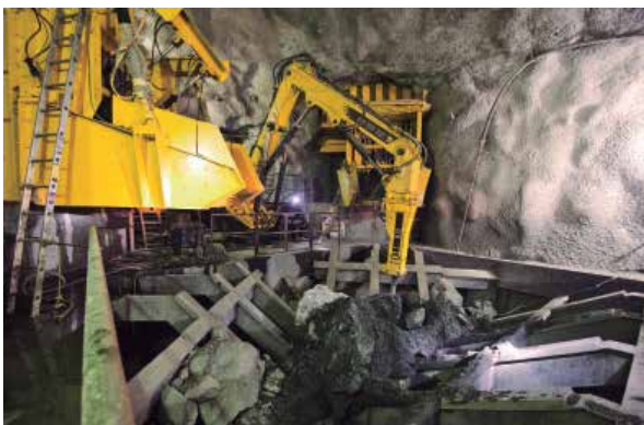
El quebrantador RB700 XD trabajando en la nueva zona de trituración de roca. La Mina Fresnillo planea alcanzar una meta de 65 millones de onzas de plata por año.
