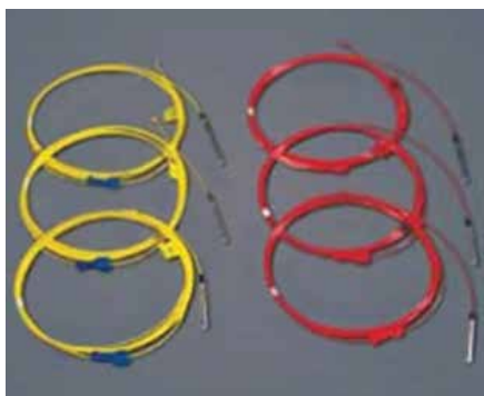
Conector plástico tipo "J": Es un bloque plástico especialmente diseñado para facilitar la conexión y asegurar el contacto entre la Manguera Fanel y el Cordón Detonante.
