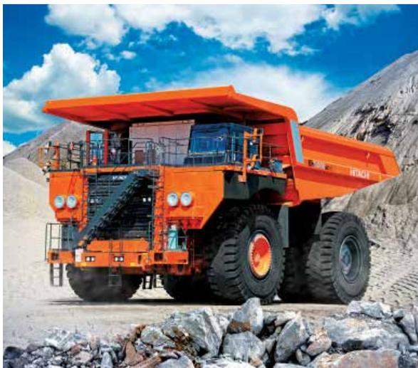
Los camiones en las versiones eléctricas (EH3500AC3, EH4000AC3 y EH5000AC3) cuentan con el más avanzado sistema de propulsión de corriente alterna fabricado por Hitachi.
