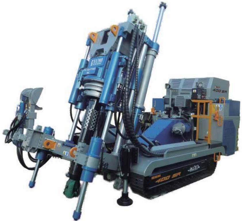
La SBM 400 SR cuenta con una Oruga Transportadora (Crawler) y Trineo de Izaje (Erection Sled) incorporado; por tanto se transporta autónomamente.
