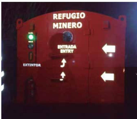
Con cualidades ignífugas, el acero dispuesto en sus paredes está conforme a las normas internacionales ASTM.
