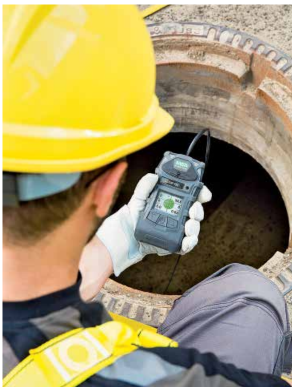
El equipo de Detección de Gases Múltiples ALTAIR 5X cuenta con la exclusiva función MotionAlert™, que envía una señal de alarma en caso de no detectar movimiento alguno del usuario.
