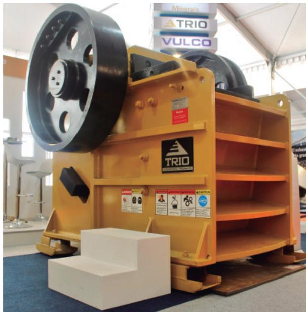
Los chancadores de mandíbula TRIO Incorporan los asientos de placa de articulación fuertemente alineados para obtener eficientes ángulos de Nip y altos rangos de producción.
