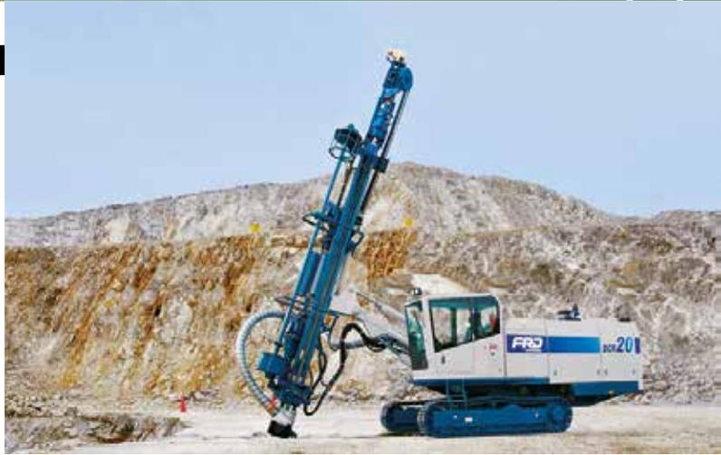
Posee una estructura reforzada que le da una alta resistencia. Es maniobrable y estable con un mantenimiento fácil y predecible. Está equipado para perforación DTH en aplicaciones mineras con presiones operativas de hasta 34.5 bar (500 psi).
