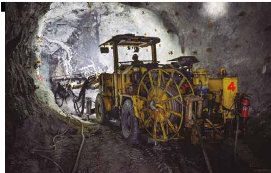
Hoy, con una rampa de 250 m terminada, los equipos mecanizados se han hecho cargo y un ciclo lleva unos 975 minutos (16,25 horas).
