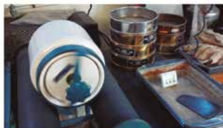
Gráfico N° 4: Prueba de moliendabilidad, molino de cerámica y tamices
