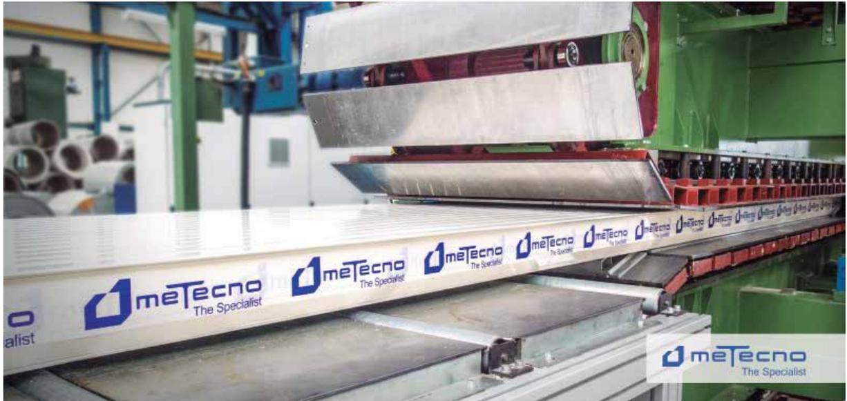
La revolución en la manera de fabricar paneles tipo sándwich con aislamiento termo-acústico la hace Metecno, con la incorporación del ciclopentano y el cambio a una nueva línea de producción.
