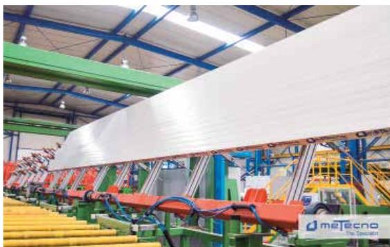
**Metecno ha decidido revolucionar la manera de fabricar paneles con la modernización de sus líneas de producción y la incorporación del ciclopentano al sistema.**
