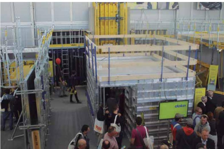
Doka también presentó en la Bauma el sistema de encofrado monolítico Doka OneGo, con este sistema se hormigona el muro y la losa de una sola vez.
