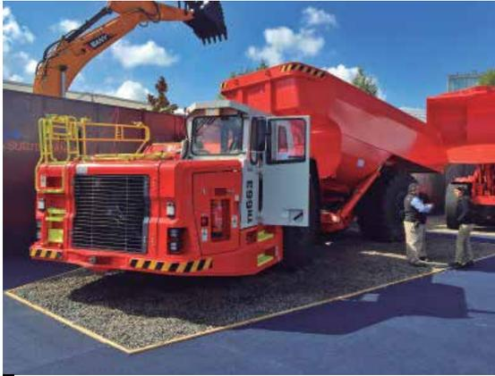
En la feria, Sandvik exhibió el camión subterráneo TH663, de 63 toneladas de capacidad, y que alcanza una velocidad de 42 km/h sin carga.
