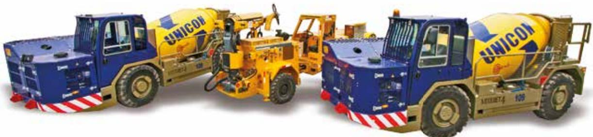
Equipos utilizados en el suministro y lanzado de concreto vía húmeda (Shotcrete).
