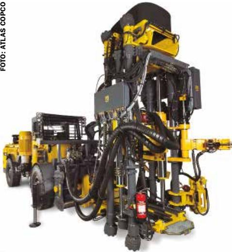
Esta perforadora de chimenea Robbins 34 RH se puede usar para escariado hacia abajo, y perforación de barrenos de cuele hacia arriba y también como una perforadora de chimenea convencional.
