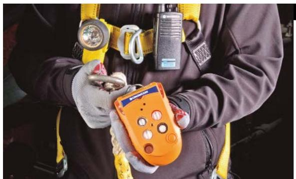
**Los sensores electroquímicos principalmente están equipados con tres electrodos, un electrodo de medida, un contra electrodo y un electrodo de referencia.**
