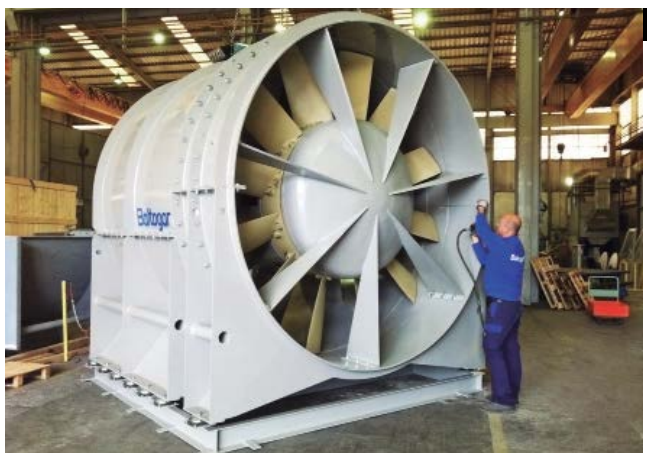
Los ventiladores helicoidales se aplican en circulación y extracción de aire en naves industriales.
