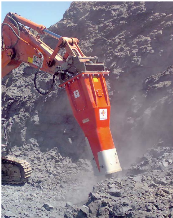
El Sandvik5011 ha sido diseñado usando un nuevo principio operacional revolucionario que combina la longitud de carrera, energía de impacto.
