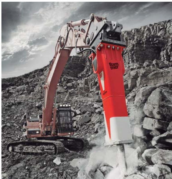
Los martillos hidráulicos Rammer, se puede utilizar en cualquier vehículo que reúna los requisitos de instalación hidráulicos y mecánicos necesarios.
