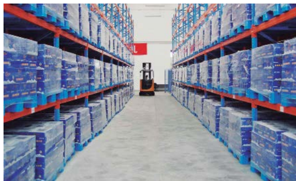
En este tipo de almacenaje se debe tomar en cuenta la resistencia de la base y la estabilidad de la columna.
