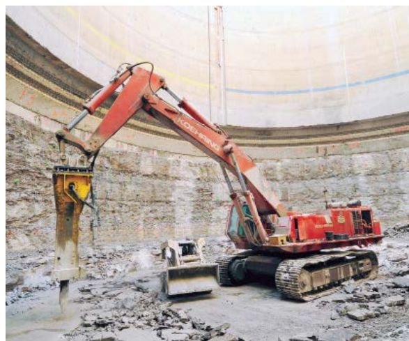
El sistema StartSelectTM, estándar en el martillo MB 1200 y superiores, permite al operario ajustar el martillo a las condiciones de trabajo actuales.
