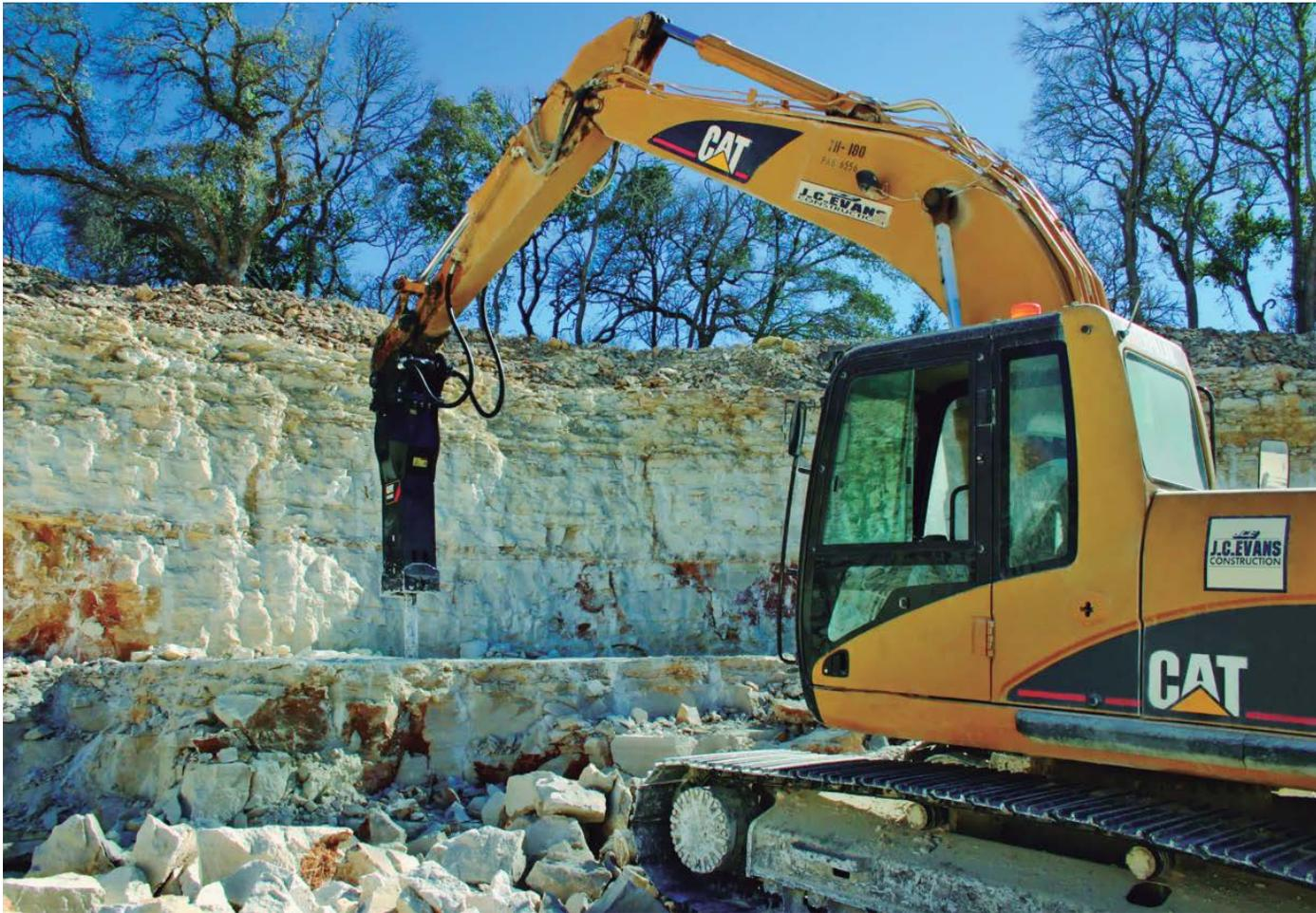
Los martillos hidráulicos ofrecen un mantenimiento fácil y sencillo. Diseñados para trabajos de apertura de zanjas, demolición de concreto y aplicaciones generales de excavación, presentan como característica un bastidor de diseño cilíndrico que posibilita un acceso mejorado a zonas restringidas. Los martillos hidráulicos están equipados de serie con una protección especial para latiguillos y racores que los resguarda cuando se trabaja cerca de la superficie o en zonas con poco espacio.
