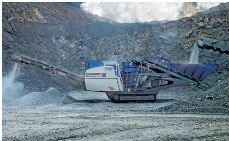
La serie MOBICONE está especialmente diseñada para la trituración secundaria y terciaria en aplicaciones difíciles de piedra.
