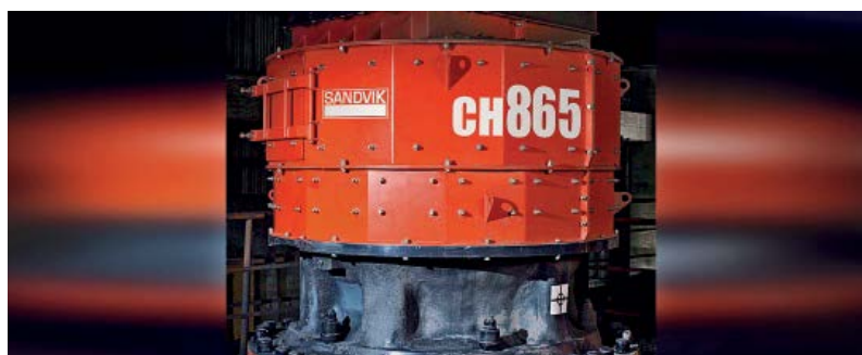
La serie Sandvik CH865 útil para aplicaciones de alta reducción terciaria y pebbles, tiene mayor fuerza de trituración en relación al diámetro del manto y un motor de 500 kW.
