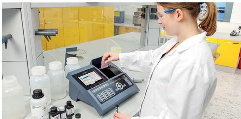
Tecnología de última generación permite a los Laboratorios modernizarse con diversos instrumentos, como el Multi 9640 que puede conectarse a una serie de sensores inalámbricos entre ellos el pH y conductividad con comunicación bluetooth en un radio de hasta 10 metros y otros como el sistema Oxitop-C/OC 100 para la determinación digital de la Demanda Bioquímica de Oxígeno (Método Estándar 5210-D, respirométrico).
